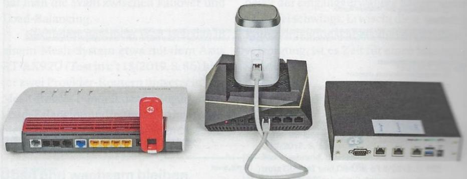
Ein USB-Mobilfunk-Stick (links) beziehungsweise ein LTE-Router (Mitte) schaffen einen zweiten Internetzugang, auf den dazu fähige WLAN-Router beim Ausfall des Hauptweges automatisch umschalten. Als Luxusvariante nutzt ein Load-Balancer (rechts) mehrere Zugänge per Lastverteilung, was nicht nur die Ausfallsicherheit erhöht, sondern auch die Internetgeschwindigkeit fürs lokale Netz.
